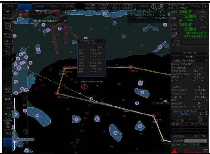
Figure 6. Capture d'écran ECDIS ; BPV et observation initiale de la position du navire de pêche.
