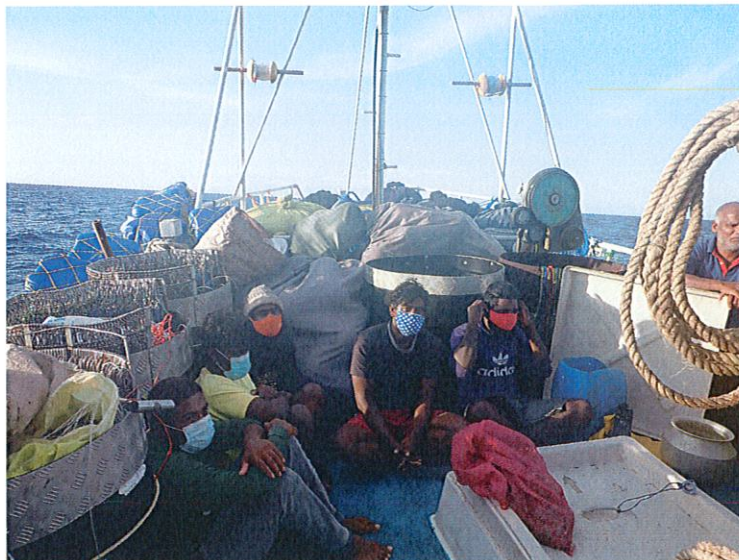
PHOTO DE L'EQUIPAGE SUR LE PONT DEVANT LE MATERIEL DE PECHE (Sacs contenant des lignes, bidons plastiques (bouées), fûts métalliques de rangement d'hameçons, treuil de relevage de ligne)
